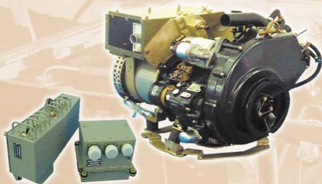
Дизель-генераторная установка ДГУ5-П27.5-ВМ1 с дизелем ТМЗ-520Д, имеющим дополнительную масляную систему охлаждения, предназначена для обеспечения электроэнергией постоянного тока бортовой сети различных машин при неработающем основном двигателе. Качество напряжения по ГОСТ В 21999-86. Обеспечивает работоспособность средств связи, комплекса вооружения, работу фильтровентиляционной установки, прицелов и приборов механика-водителя, зарядку аккумуляторных батарей. Дизель-генераторная
