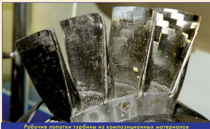
**Рабочие лопатки турбины из композиционных материалов**
