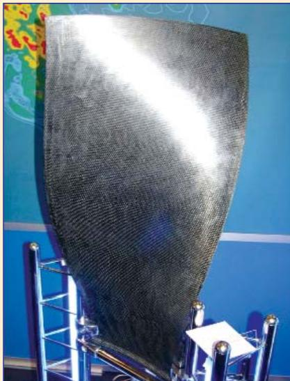
**Лопатка РК модернизированного КНД из полимерного композита**
