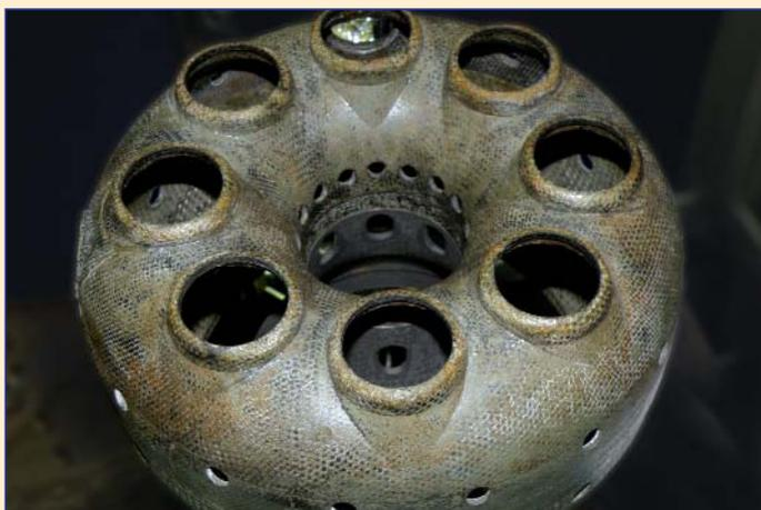
**Жаровая труба из керамического композиционного материала**
