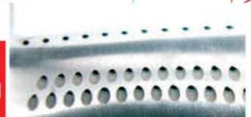
Технология микроэрозионной обработки **SARIX** отличается высокой надёжностью и повторяемостью процесса. Производственный станок **SARIX** используется главным образом для обработки отверстий размером от 50 микрон до 3 мм.
